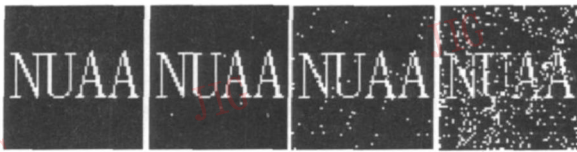
图 5 不同 JPEG 压缩下提取的水印图像 Fig 5 The extracted watermark after different JPEG compression ratios
